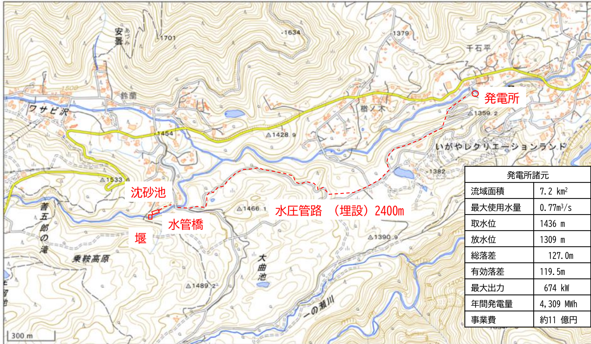
図 設備配置案 設備配置、最大使用水量、落差等は全て今後の調査で詳細決定していきます。
